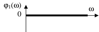
*Rem 2 : cette FT est parfaitement réalisable : elle correspond à un simple pont diviseur de tension avec  $a = R_2 / (R_1 + R_2)$ !*
