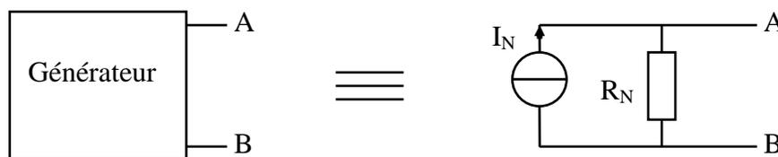
**Ex :** dans le circuit ci-contre, on veut calculer U en remplaçant le générateur vu par  $R_4$  par son générateur de Norton équivalent.
