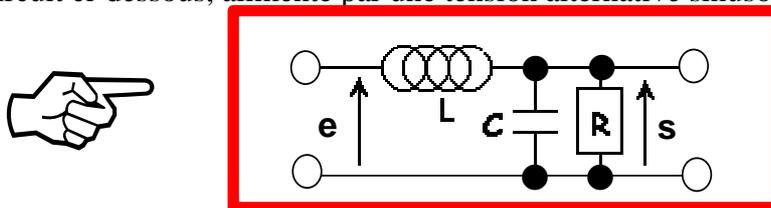
1. Déterminer la fonction de transfert  $\underline{H}(j\omega) = \frac{s}{e}$  du montage en fonction de  $x = \frac{\omega}{\omega_0}$  avec  $\omega_0 = \frac{1}{\sqrt{LC}}$  et
