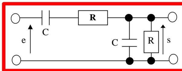
1) La fonction de transfert  $\underline{H}(j) = \frac{s}{e}$  du montage s'écrit:  $H = \frac{Z_c // R}{(R + Z_c) + Z_c // R}$  avec:
