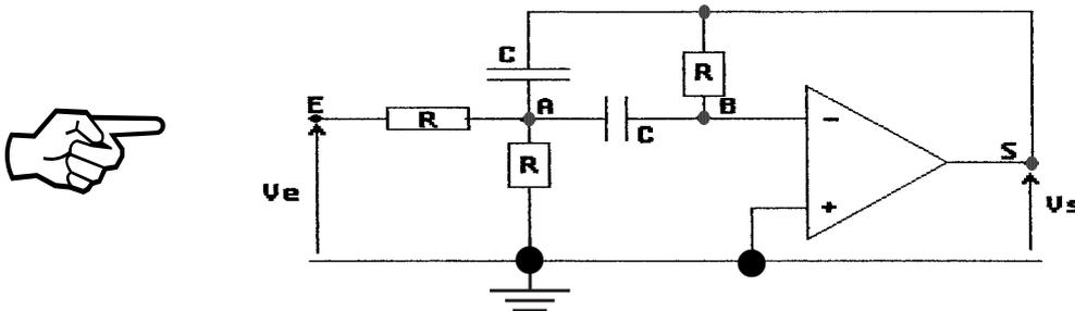
1°) Déterminer La fonction de transfert de ce filtre:
