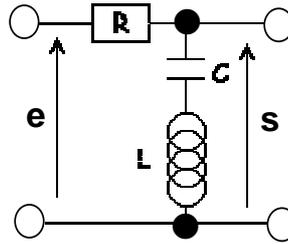
1°) La fonction de transfert  $\underline{H}(j\omega) = \frac{s}{e}$  du montage s'écrit:
