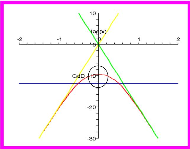
3) L'argument de la fonction de transfert :  $\varphi = \arg[\underline{H}(j\omega)] = -\arctg \frac{(x - \frac{1}{x})}{3}$
